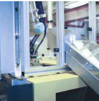
ロボットは、射出成形機に固定されており、金型の上に移動し、プラスチック製のアイテムを取り出します。これらの作業は、繊細な商品が損傷しないよう、特別に設計された真空システムを用いて行われます。
