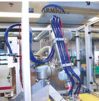
オーティコン社は、同じ工場の中で、マテリアルハンドリング用ロボットとしても使用しています。ロボットにエアークリッパーを装着し、より複雑な部品をハンドリングします。ロボットは、4秒から7秒のサイクルで動作します。
