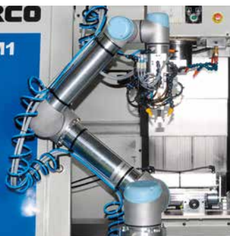
ロボットは、両方の扉を開くワークピースを入れ、加工後また、その物を取り出し置く。
